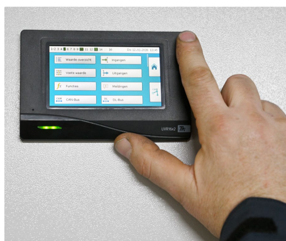
— De display geeft in één oogopslag inzicht in het systeem, inclusief de aanvoer- en retourtemperatuur van het water.
