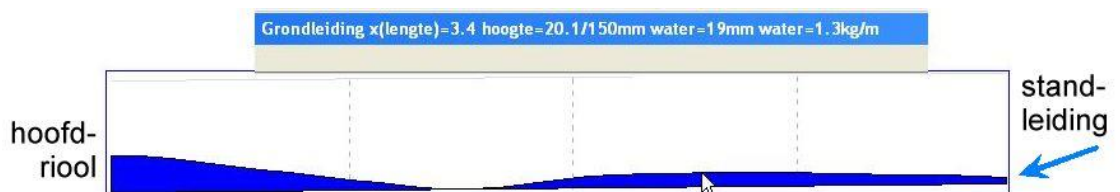
Figuur 5: De grondleiding in proRiool
