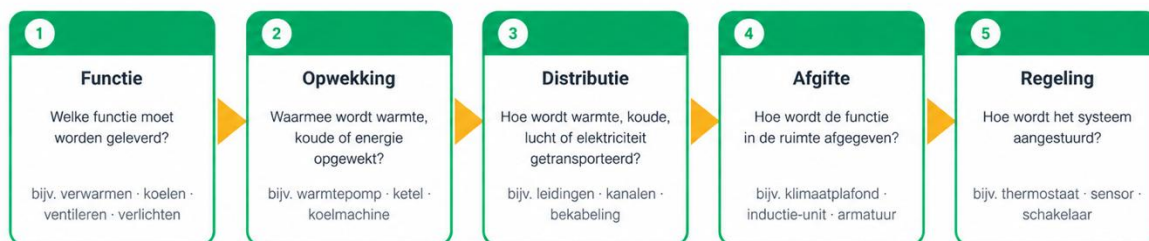
Figuur 4.1 – Functionele opbouw van installatieconcepten volgens FODAR.
