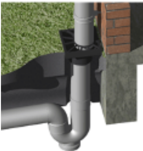
Ontlastputje met stankafsluiter in aansluiting van hemelwaterafvoer op buitenriolering van een gemengd stelsel.
